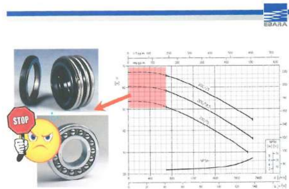
استفاده از پمپ در دین های پایین (تا ۱۰۰ درصد دین بهترین راندمان) باعث فرسایش بیش از حد بویلر ها و مکانیکال سیل ها می شود.
